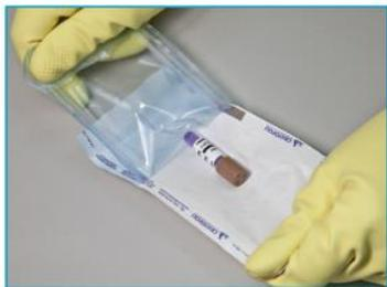
Terminado o ciclo de esterilização, aguarde 15 minutos para o resfriamento. Abra o envelope e recupere a ampola teste autoclavada
