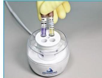
Repita essa mesma operação na ampola controle e coloque as 2 ampolas para incubar por 24 ou 48 horas, dependendo do indicador utilizado.
