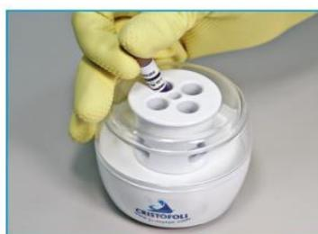
Introduza a ampola teste dentro da incubadora para ativá-la, dobre a parte superior da ampola plástica flexível. Isto resultará na quebra da ampola interna de vidro, liberando o meio de cultura para contato com os esporos. Cuidado para não romper a parte plástica
