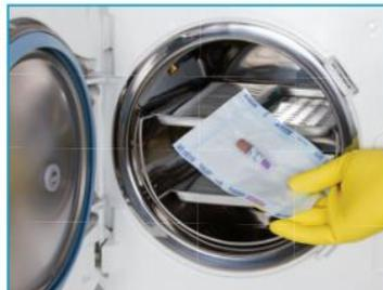
Coloque um indicador em um envelope dentro da autoclave já abastecida com um ciclo padrão.
